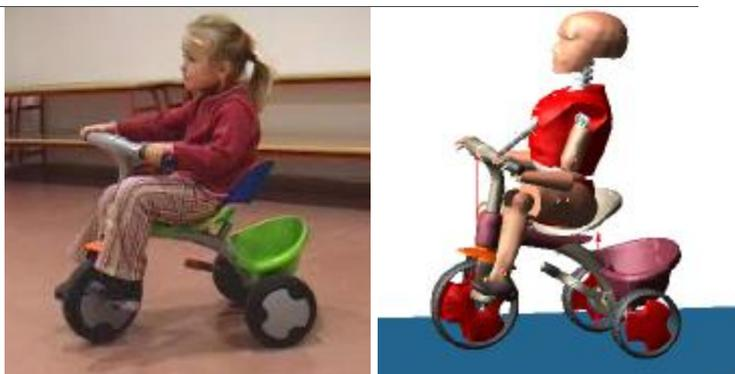
Comparativa entre un ensayo ergonómico virtual realizado sobre un modelo 3D y un ensayo realizado sobre el modelo real (triciclo Soft Trekk cedido por de la empresa Picó-Smoby)
