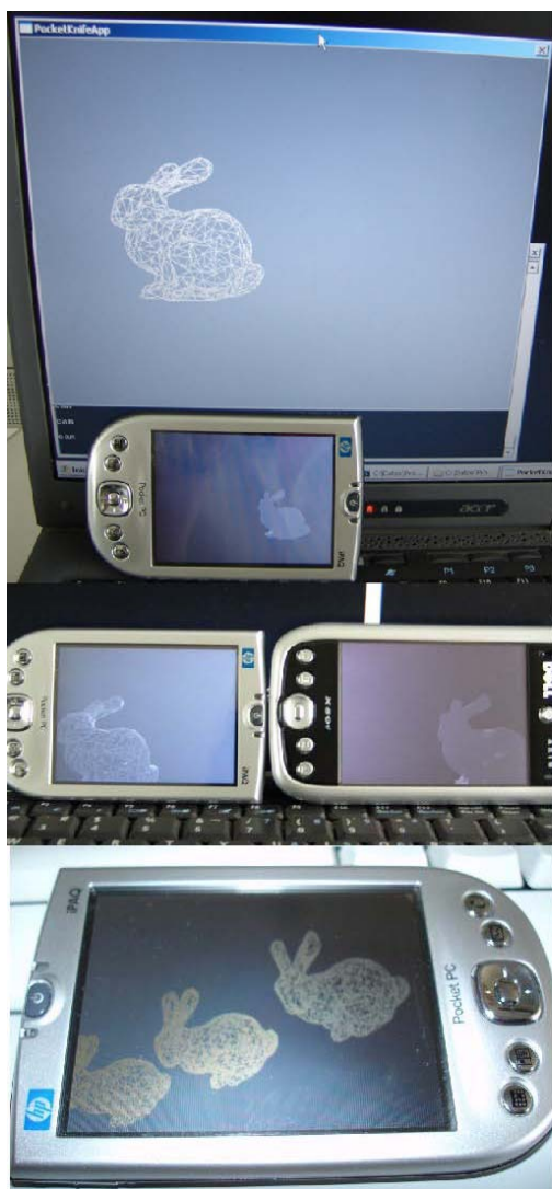
Figura 6. Imágenes del sistema funcionando: arriba el servidor y un cliente, en el centro dos clientes con la misma escena, y abajo con una escena formada por varias mallas multiresolución
